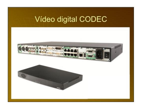
La siguiente diapositiva es una imagen de la parte posterior de un codec de hardware. Hay entradas de micrófono, entradas de vídeo y audio y las salidas de monitor, conectores y entradas para diferentes tipos de sistemas de red. La clave para adquirir el codec apropiado es que va a interactuar con todo el equipo que desea conectar al codec.
