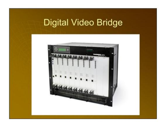
La siguiente diapositiva es una foto de un puente Tandberg MPS que se puede montar en bastidor.
